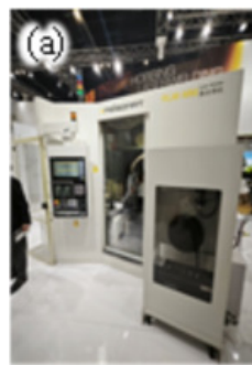
图28 瑞士菲索玛特FLW 400柔性激光焊接机床 京创（天津）激光和邦德激光推
