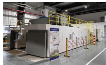
图38 中国机械总院集团江苏分院有限公司的Gm6025大型超声复合钻铣五轴龙门数控机床
