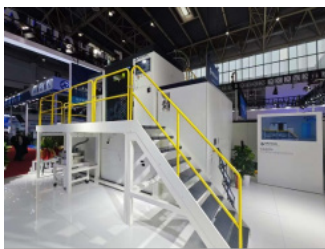
图30 宁波海天增材公司展出的C650M中大型SLM金属3D打印机
